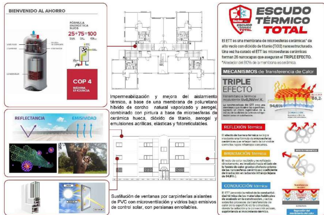
Figura 1. Esquema de medida de mejoras a aplicar en la rehabilitación energética de uno de los bloques de viviendas VPP situados en la zona climática alfa3, aplicando en fachadas pinturas térmicas, compuestas por microesferas cerámicas huecas y pigmentos reflexivos basados en nanotecnología, y la impermeabilización y mejora del aislamiento térmico de las cubiertas, a base de una membrana de
