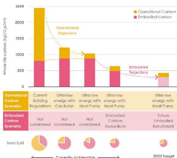
Figura 1. Trayectoria estimada del impacto relativo de las emisiones operativas frente a las embebidas en el periodo 2020-2050. Fuente: LETI Climate Emergency Design Guide. https://www.leti.uk/cedg
